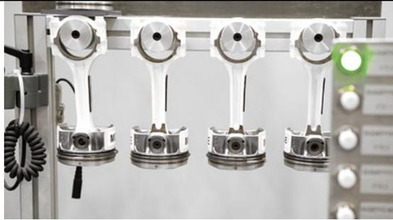
**Gefragt ist Feinarbeit: Das obere Foto zeigt die Aufbereitung von Kolbenbolzen, das rechte einen Motorblock, befestigt an einem Montagegestell**
