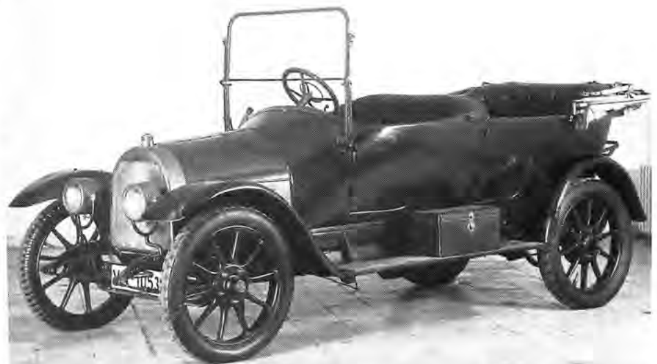
Opel „Torpedo 6/16 PS – Baujahr 1911 – Geschwindigkeit 60 – 65 km – Preis: 5.750 Mark. Vierzylinder-Motor – Magnetelektrische Hochspannungszündung – Baggerölung – Thermosiphonkühlung mit Ventilator (Röhrenkühler) – Kulissenschaltung – vier Vorwärts-, ein Rückwärtsgang – konische Lederkupplung.
