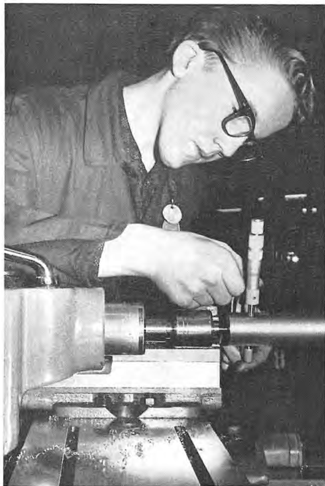
DREHERLEHRLING D. Gläser dreht eine Welle zwischen Spitzen. Auf Maßgenauigkeit kommt es besonders an.
