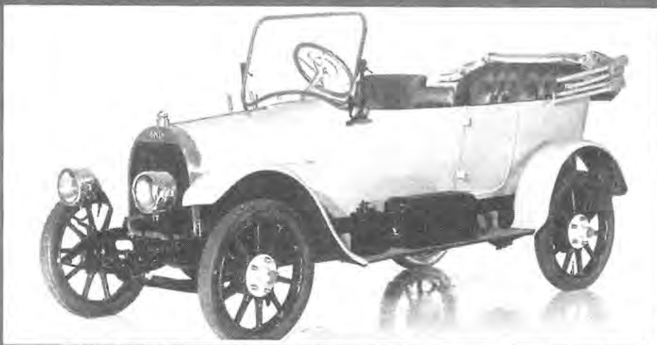
Das Bild zeigt den Opel 5/14 PS Viersitzer mit geschlossenem Führersitz, Baujahr 1913/14. Technik: Vierzylinder-Blockmotor mit seitlich angeordneten Ventilen – Bohrung 65 mm – Hub 105 mm – Hubraum 1390 ccm – Leistung ca. 15 PS bei 1.800 U/min – Wasserkühlung (Röhrenkühler und Ventilator) – Magnet-elektrische Zündung – Baggerölung – Vergaser „System Opel“ – Viergang-Getriebe mit seitlicher Kulissenschaltung – Geschwindigkeit 55 km/h. Preis: 5.650,- Mark.
