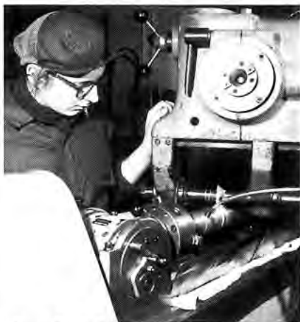
Der Auszubildende A. Engelhardt beim Fräsen einer Spezial-Reibahle auf einer Universalfräsmaschine unter Verwendung eines Universal-Teilapparates.
