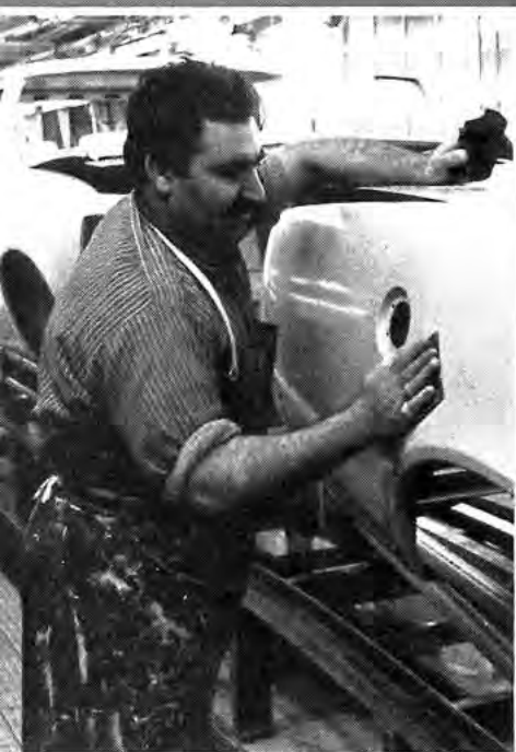
Kleine Unebenheiten in der Grundlack-schicht werden glatt geschliffen, hier von Mitarbeiter B. Kuecuegoencue.
