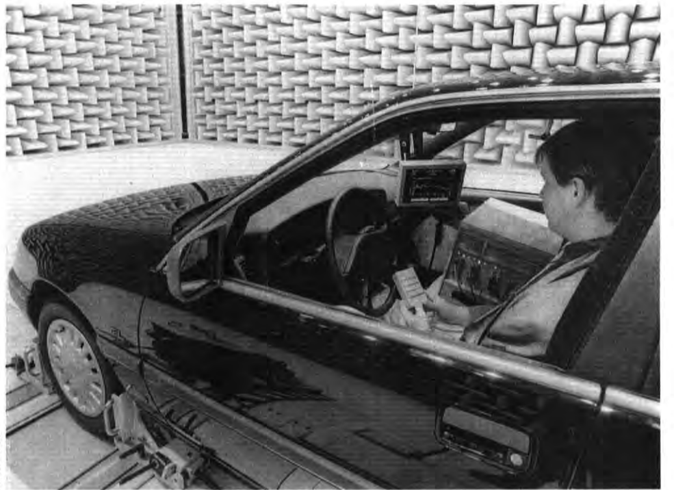
Meß-Verfahren: Fahrgeräusche werden im Stehen gemessen
