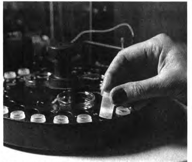
Analyse: Abwasser wird auf Schwermetall untersucht
