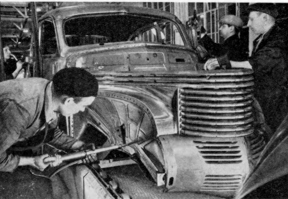
Bild oben: Schritt für Schritt fährt die Karosserie langsam vorwärts, wenn auch nicht auf eigenen Rädern, so doch auf dem laufenden Band. Der Radeinbau wird mittels Stoßpunkter an den Kapitän-Unterbau angepunktet.
