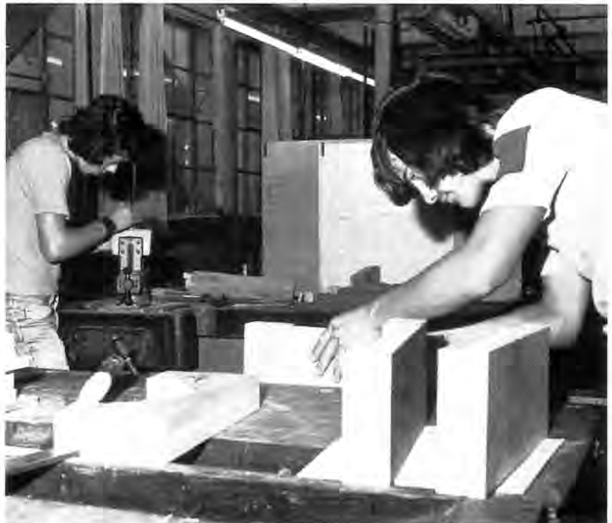
Mathias Ziesche (rechts) und Ottmar Lapp sind auszubildende Modelltischler im 3. Ausbildungsjahr. Unser Bild zeigt sie beim Anfertigen eines Gießmodells Seitenwandvorrichtung.
