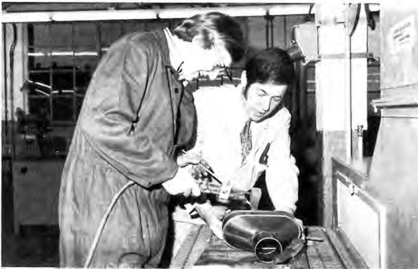
Der auszubildende Feinblechner H. Palus bei einer Weichlötarbeit an einem Verteilerkasten. Rechts Meister G. Ranly.
