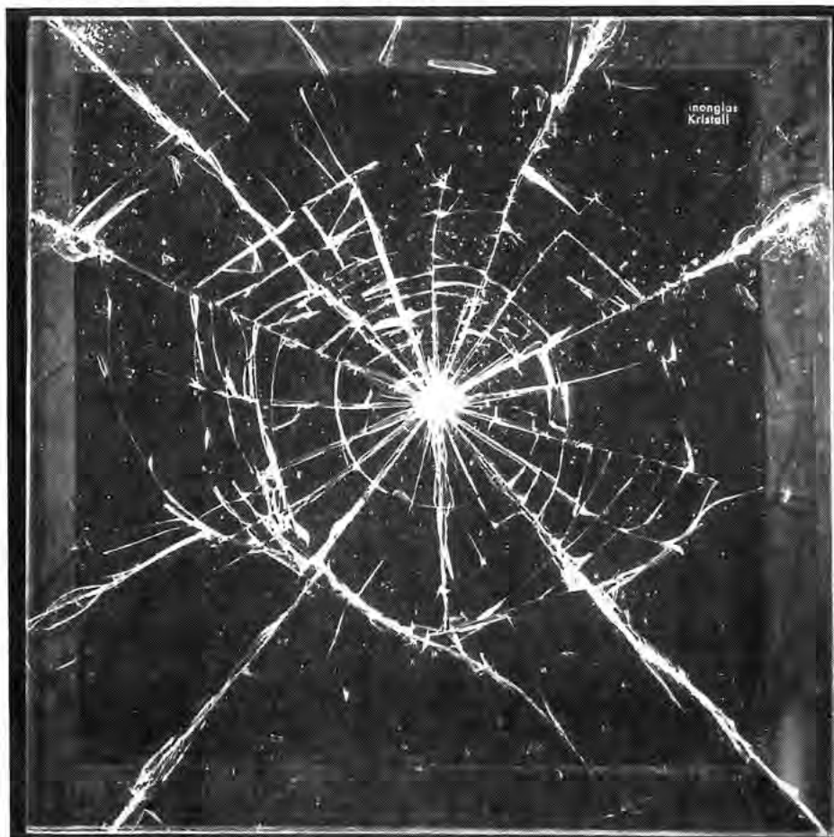
Bruchbild einer VSG-Scheibe (Verbundglas).
