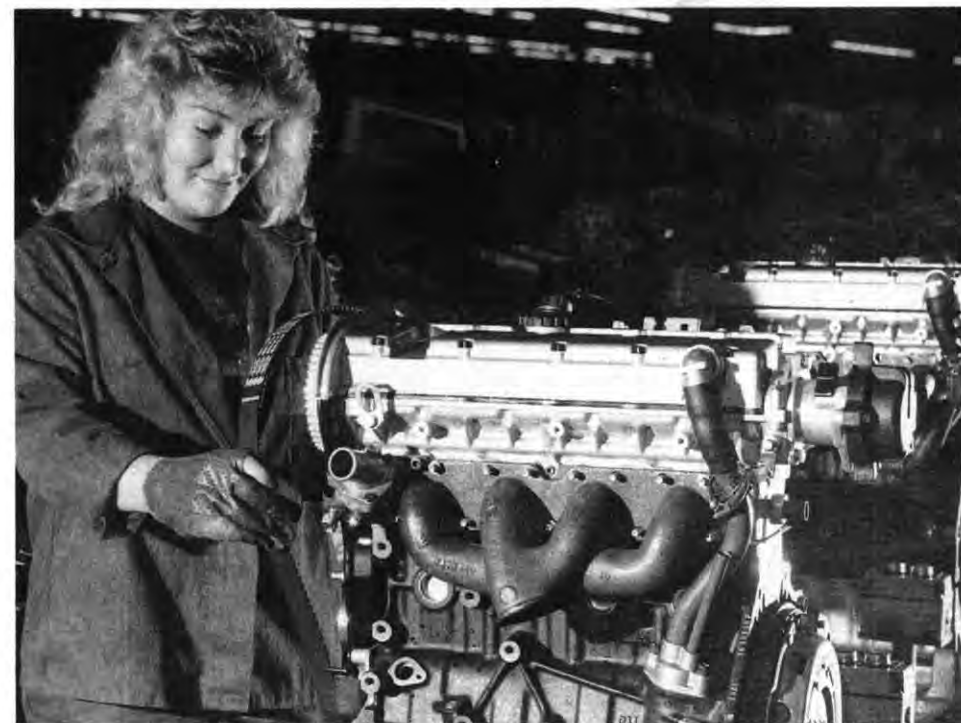
Ein weiterer Schritt in der Endmontage ist die Anbringung des Zahnriemens. Hier arbeitet Esther Christmann
