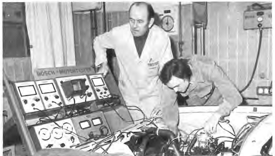
Der Auszubildende Ulrich Klein steht kurz vor seiner Abschlußprüfung. Auf unserem Bild sucht er mit Hilfe des Motortesters einen Fehler an der Zündanlage. Links Ausbildungsmeister A. Totzauer.
