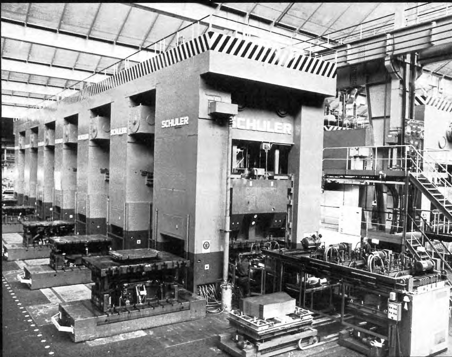
Blick auf die neue vollautomatische Pressenstraße im K 67. Vorn der im Text erwähnte Platinenlader, der die Platinen in die Ziehpresse transportiert.
