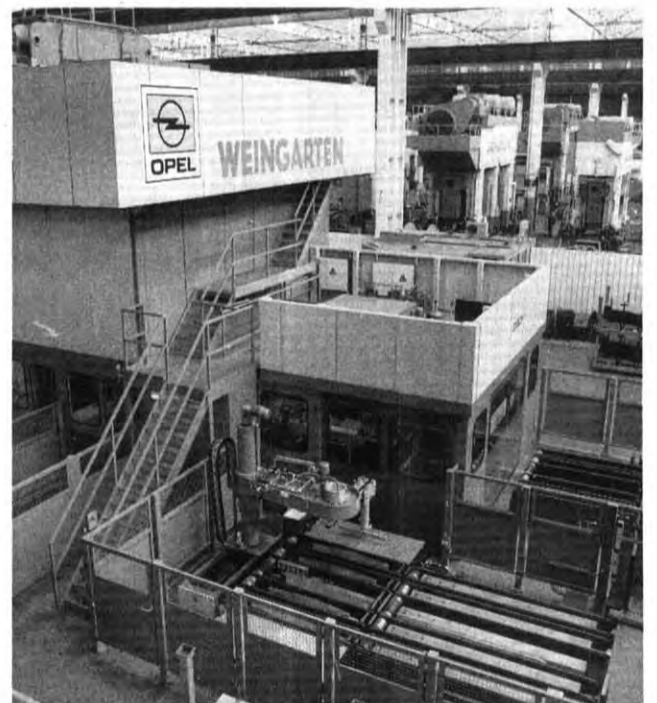
Leisetreter: Großtransferpressen mit Schalldämmung
