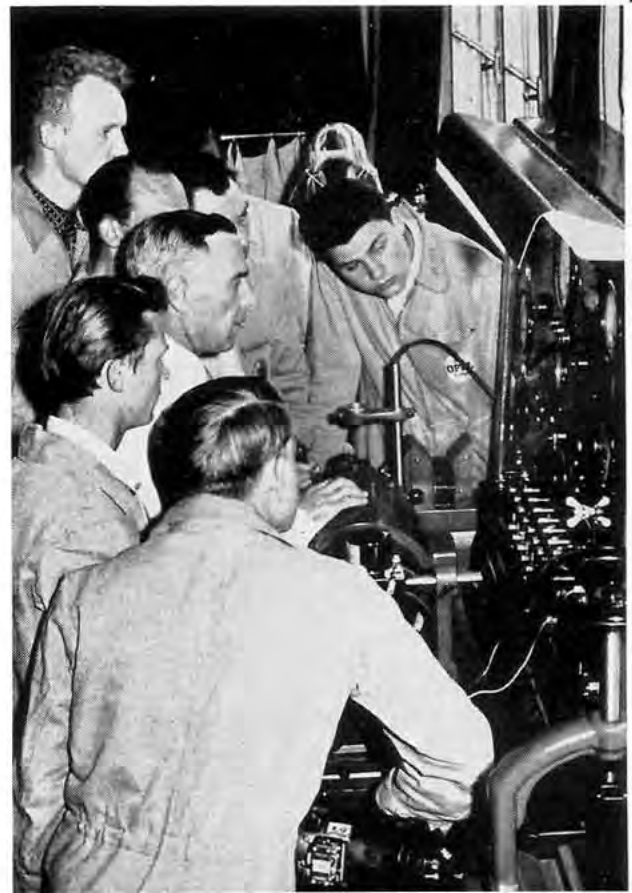
LEHRGANG FÜR KFZ.-ELEKTRIKER. Lehrgangsleiter P. Schmiege erklärt die Bedienung eines modernen Prüfstandes. Den Lehrgangsteilnehmern wird vorgeführt, wie man Fehler an den elektrischen Aggregaten einkreisen und erkennen kann.
