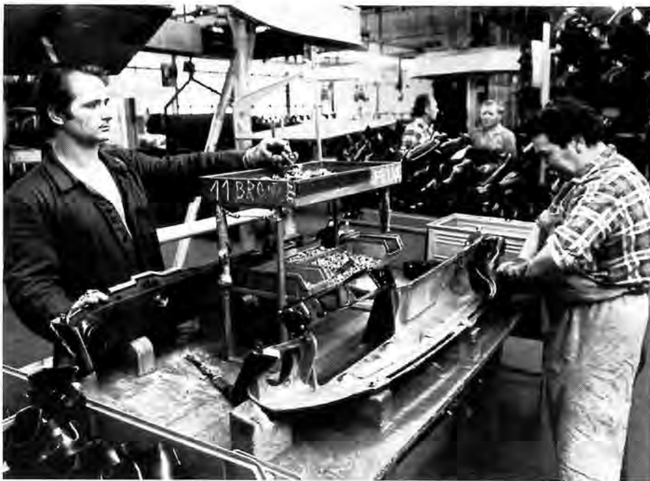
Die Montage der Armaturentafel-Oberteile war früher in mehrere Arbeitsgänge zerlegt und wurde auf kleinen Bändern durchgeführt. Heute ist einem Mitarbeiter die Vormontage der Befestigungselemente und der nachfolgende Einbau übertragen. Unser Foto entstand in der Fertigmontage des Rüsselsheimer Werkes und zeigt links Mitarbeiter F. Forte und rechts R. Romero. Ebenfalls ein Beispiel für die „Arbeitsbereicherung“.
