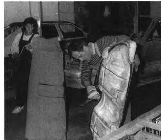
Demontage: Trennung nach Werkstoffen
