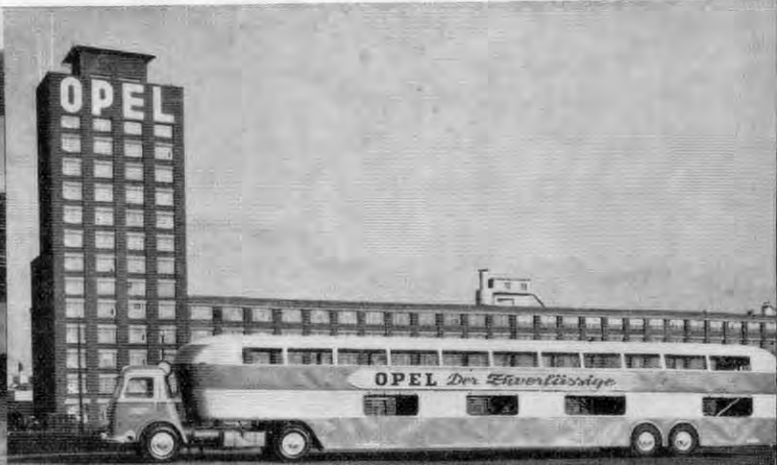
Zur Überführung von neuen Opel-Wagen zu den Opel-Großhändlern wird neuerdings ein Großraum-Transporter eingesetzt. Das zweistöckige Fahrzeug nimmt im oberen Stockwerk 5 Olympia (oder Kapitäne) auf, während darunter 4 Olympia Platz haben.
