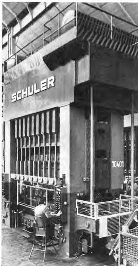
320 Pressen unterschiedlicher Größe und Leistung stehen im Bochumer Preßwerk. Hier werden fast 1000 Einzelteile des Kadett gefertigt. Unser Bild zeigt die Pressenstraßen 19 und 20. (oben)
