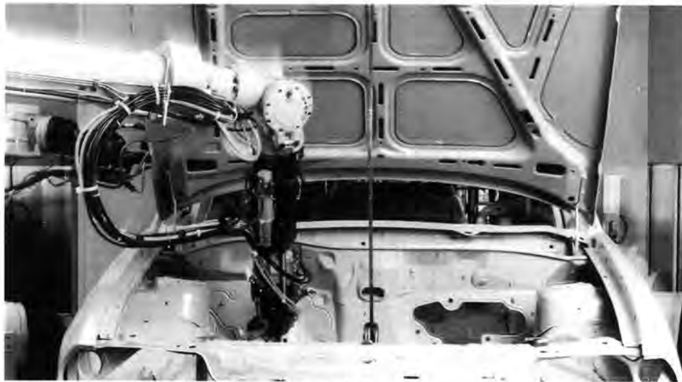
Präzision: Erstmals Nahtversiegelung per Roboter
