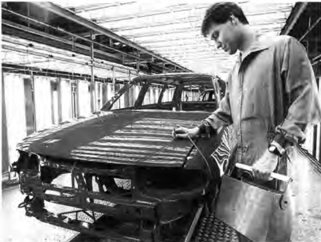
Kontrolle: Lackschicht im Speziallicht
