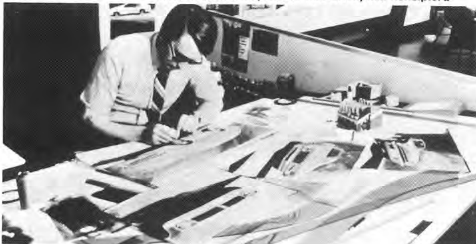
Geschickte Hände formen ein Plastilinmodell im Maßstab 1:5.
