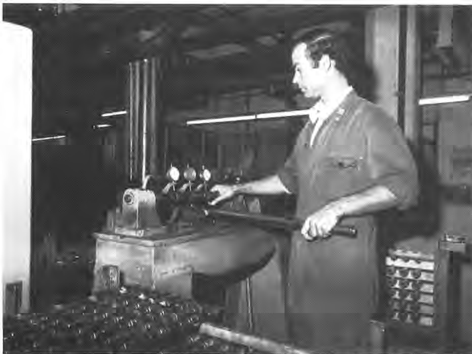
Mitarbeiter Ezequiel Baptista Vieira beim Richten einer Nockenwelle für den Diesel-Motor des Rekord.
