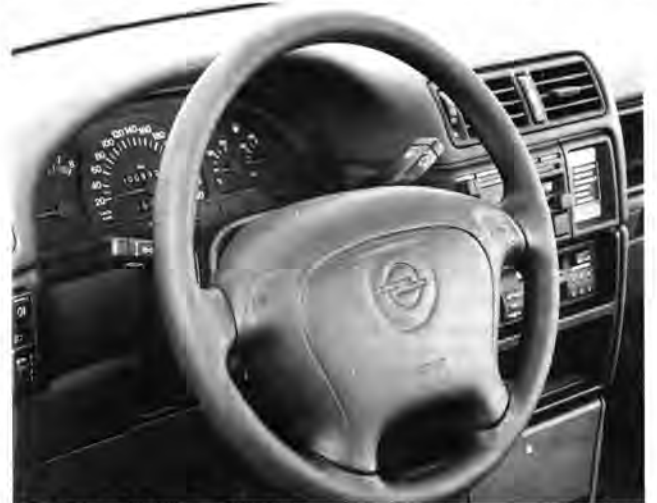
Lenkrad: Airbag in der Nabe
