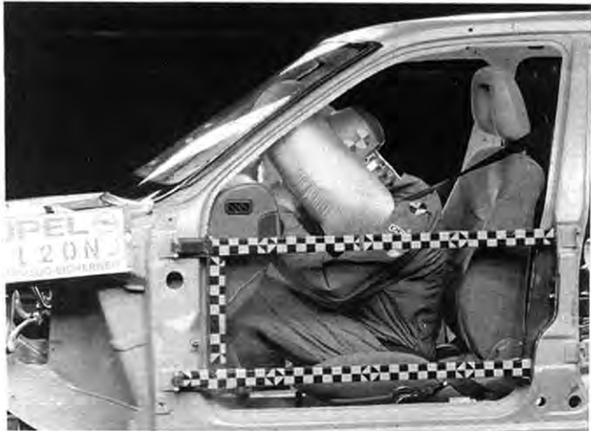
Augenblick: Ein Dummy fällt in das aufgeblasene Luftkissen
