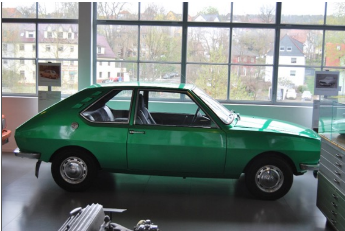
12: Wartburg 355 als Prototyp mit Viertaktmotor und Fließheckkarosserie.
