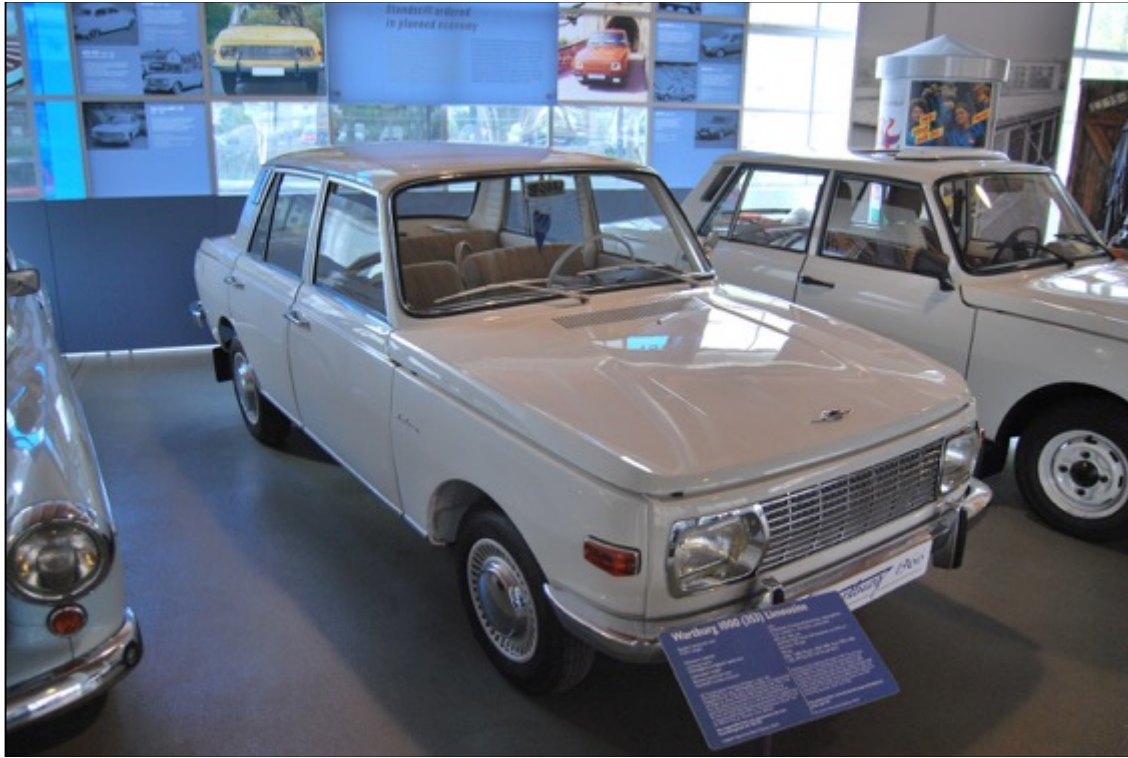
11: "Das sozialistische Auto" bezeichnete der Formgestalter Carl Clauss Dietel seinen Entwurf zum Baumuster 353. In der Tat waren die klaren Formkanten und die funktional gestalteten Details Merkmale des offenen Prinzips, wie es im Bauhausstil geprägt wurde. Schnörkel oder Blenden glänzen durch Abwesenheit und werden nur geduldet, wenn sie durch eine klare Funktion begründet werden können. 1966 ein Novum auf dem internationalen Automobilmarkt. Bereits 5 Jahre später jedoch kalter Kaffee. Im Hintergrund ist ebenfalls ein 353 zu sehen, allerdings aus dem Modelljahr 1988. Auch wenn das Fahrzeug nur halb erkennbar ist, viel hat sich nicht geändert.
