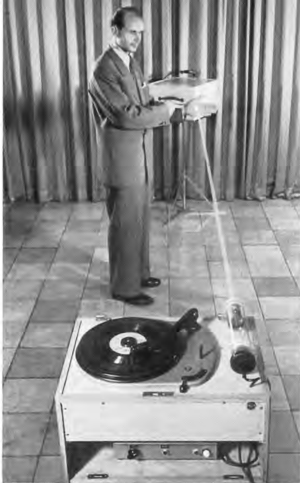
EINE PUNKTLICHTLAMPE gibt mit feinen Änderungen ihrer Helligkeit Tonschwingungen, die von der Schallplatte des Senders stammen, zur Fotozelle des Empfängers weiter. Diese Zelle leitet die Wandlung der Lichtimpulse in hörbare Töne ein. Mitarbeiter B. Fischer beweist mit einem verblüffenden Versuch, wie man durch Beeinflussung des Lichtstrahls den Takt der Musik verändern kann.
