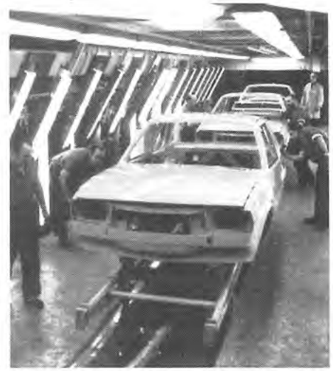
LINKS: Vorbereitende Korrosionsschutz-Operation, um jene Teile ausreichend zu schützen, die wegen ihrer verdeckten Lage später in der Lackiererei nicht mehr oder nur schwer zu erreichen sind. – MITTE: Eine von vielen Operationen im Bereich der Lackiererei. – RECHTS: Kontrolle von fertig lackierten Karosserien im Lichttunnel der Lackiererei.
