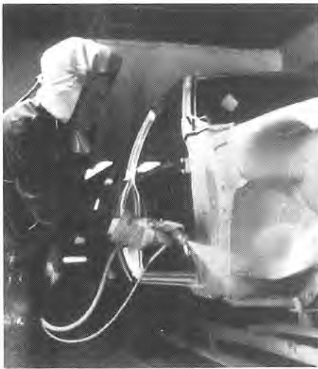
LINKS: Vorbereitende Korrosionsschutz-Operation, um jene Teile ausreichend zu schützen, die wegen ihrer verdeckten Lage später in der Lackiererei nicht mehr oder nur schwer zu erreichen sind. – MITTE: Eine von vielen Operationen im Bereich der Lackiererei. – RECHTS: Kontrolle von fertig lackierten Karosserien im Lichttunnel der Lackiererei.
