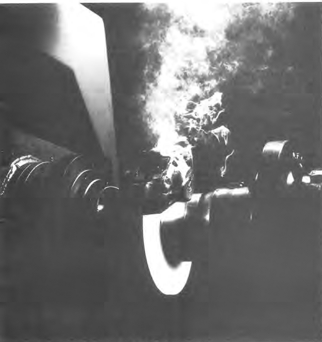
Bremsscheibe bei einem Test auf dem Prüfstand.
