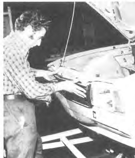
LINKS: Einige Stationen weiter: Scheinwerfermontage. – MITTE: Wieder ein paar Schritte weiter in der Fertigungsmontage: Einsetzen des Kühlergitters. – RECHTS: Und hier sind wir schon in der ersten Phase der Endmontage: Auf dem Bodenförderer nähern sich Motor, Getriebe und Achsen. Die fertig ausgestattete Karosserie senkt sich gerade auf diese Aggregate herab und wird mit ihnen verbunden: „Hochzeit“ nennt man das im Betriebsmund.
