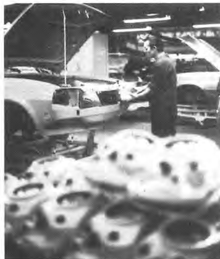
LINKS: Einige Stationen weiter: Scheinwerfermontage. – MITTE: Wieder ein paar Schritte weiter in der Fertigungsmontage: Einsetzen des Kühlergitters. – RECHTS: Und hier sind wir schon in der ersten Phase der Endmontage: Auf dem Bodenförderer nähern sich Motor, Getriebe und Achsen. Die fertig ausgestattete Karosserie senkt sich gerade auf diese Aggregate herab und wird mit ihnen verbunden: „Hochzeit“ nennt man das im Betriebsmund.
