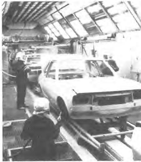
LINKS: Vorbereitende Korrosionsschutz-Operation, um jene Teile ausreichend zu schützen, die wegen ihrer verdeckten Lage später in der Lackiererei nicht mehr oder nur schwer zu erreichen sind. – MITTE: Eine von vielen Operationen im Bereich der Lackiererei. – RECHTS: Kontrolle von fertig lackierten Karosserien im Lichttunnel der Lackiererei.
