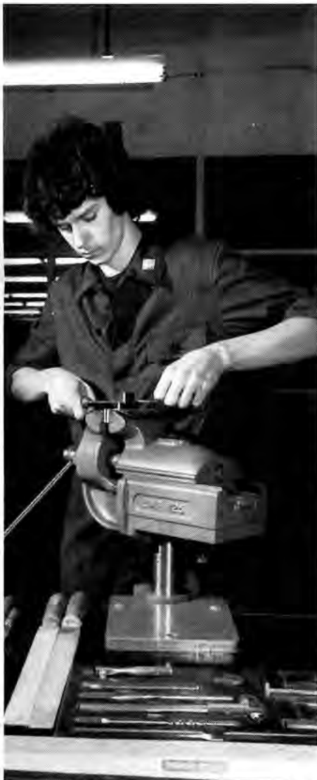
M. Bode befindet sich im ersten Jahr seiner Ausbildung zum Werkzeugmacher. Das Bild zeigt ihn beim Feilen und Einpassen einer Rechteckflachlehre.
