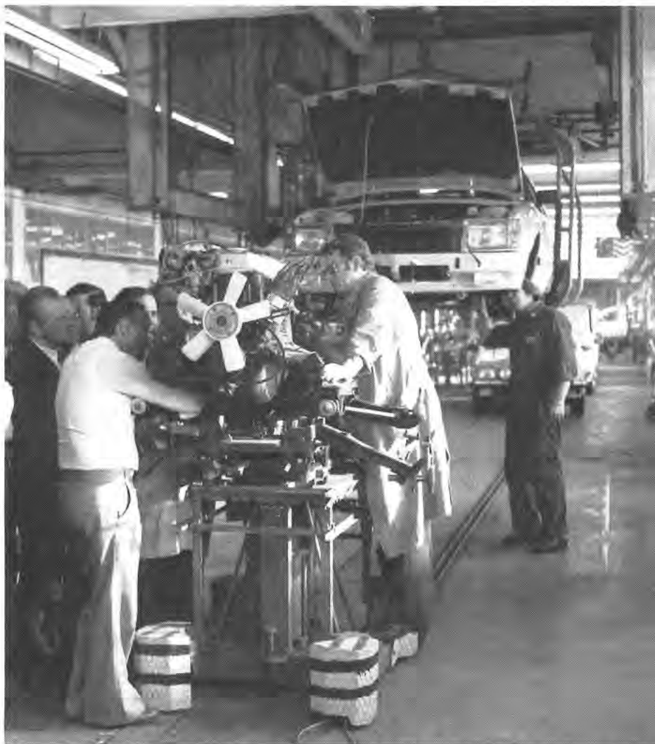
Interdisziplinäre Diskussion im Rüsselsheimer Pilotwerk: Experten aus Konstruktion, Planung und Produktion beraten die Montagefolge an einem Sechszylinder für den Senator.
