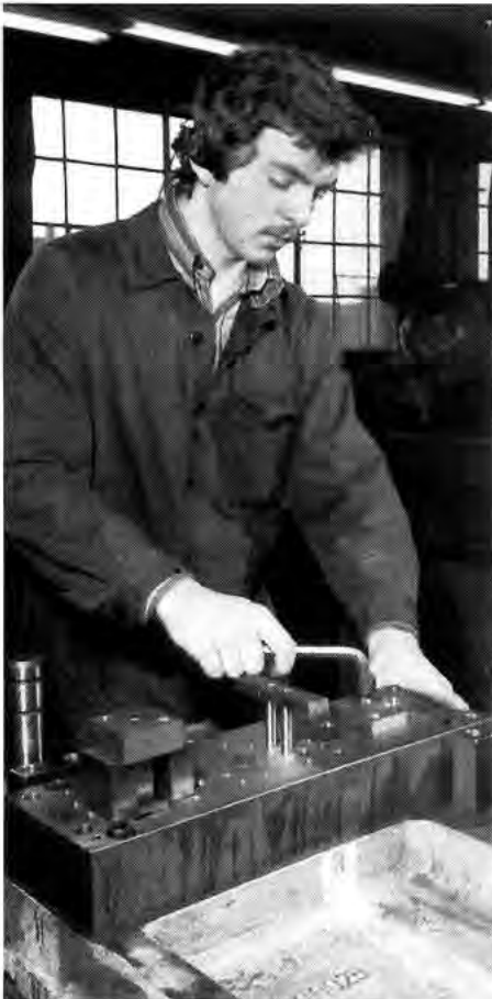
Der Auszubildende H. Schipper ist im dritten Lehrjahr seiner Ausbildung zum Werkzeugmacher. Unser Bild zeigt ihn bei der Herstellung eines Folgewerkzeuges für das Preßwerk.
