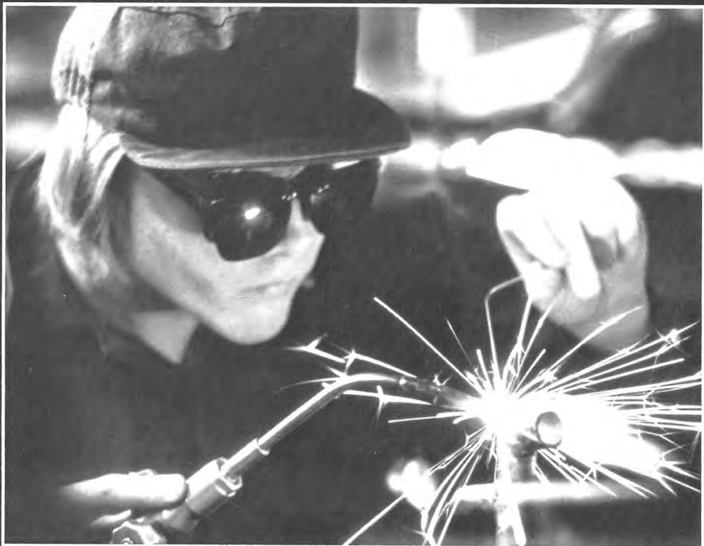
Grundlehrgang im Autogenschweißen, das alle Auszubildenden der metallverarbeitenden Berufe, aber auch die Elektriker und die Technischen Zeichner erlernen müssen.
