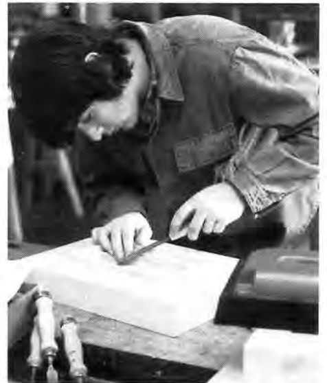
Kl. G. Heuss wird zum Bohrwerksdreher ausgebildet. Unser linkes Bild zeigt ihn an einem Horizontalbohrwerk. — H. J. Hoppe hat den Beruf des Modelltischlers als Ausbildungsziel gewählt. Auf unserem rechten Bild korrigiert er die Innenkonturen eines Kernkastens.
