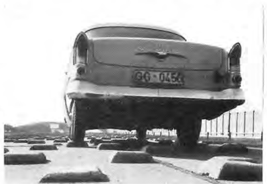
AUS DER FROSCHPERSPEKTIVE beobachten wir, wie auf einer der Märterstrecken des Prüffeldes alle Fahrzeugteile einer hohen Beanspruchung unterzogen werden
