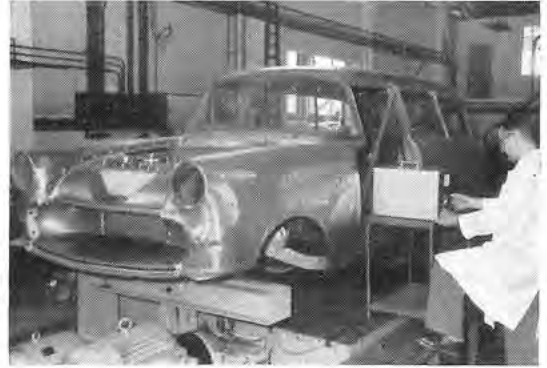
BEI BEANSPRUCHUNGSMESSUNGEN auf dem Karosserie-Verwindungsstand ist hier Dipl.-Ing. O. Grube aufgenommen
