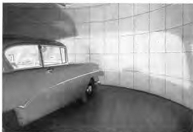
LICHTFELDBESTIMMUNG. In Augenhöhe des Fahrers sind zwei Glühlampen angebracht, die einen Schattenriß des Lichtfeldes auf einen Rundschirm werfen
