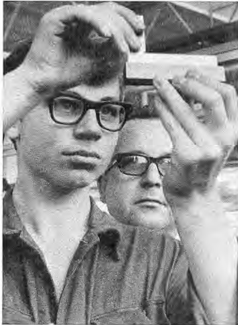
Lehrling W. Abrolat beim Prüfen seiner ge- feilten Fläche. Meister F. Sieberg schaut mit Kennerblick zu, ob es richtig gemacht wird.
