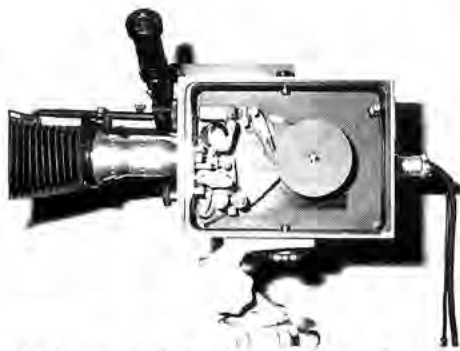
Abbildungen 2/2a: Schematische Darstellung einer Kamera mit intermittierendem Filmtransport. — Hochgeschwindigkeitskamera (Gehäuse geöffnet) für stationären Einsatz (16 bis 500 B/S).
