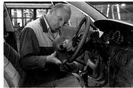
Kontrolle: Airbag wird eingesetzt
