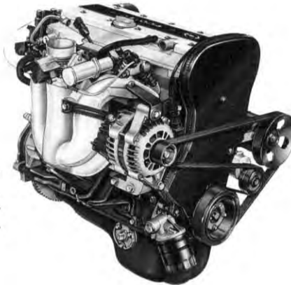
Alles Gute: Vierventiler, Klopfensoren, Direktzündung für den neuen Zweiliter
