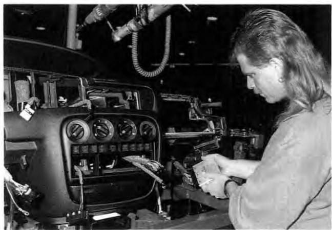
Einbau: Steuerggerät für Wegfahrsperr
