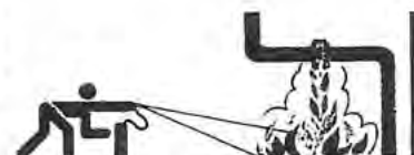
Aber: Tropf- und Fließbrände von oben nach unten löschen
