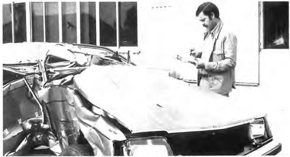
Unfallsachbearbeiter Werner Baum beim Vermessen und Untersuchen eines Unfallfahrzeuges. Die hierbei und den anderen Untersuchungen gesammelten Daten werden nach der Erfassung auf Lochkarten geschrieben und für statistische Zwecke im Computer gespeichert.
