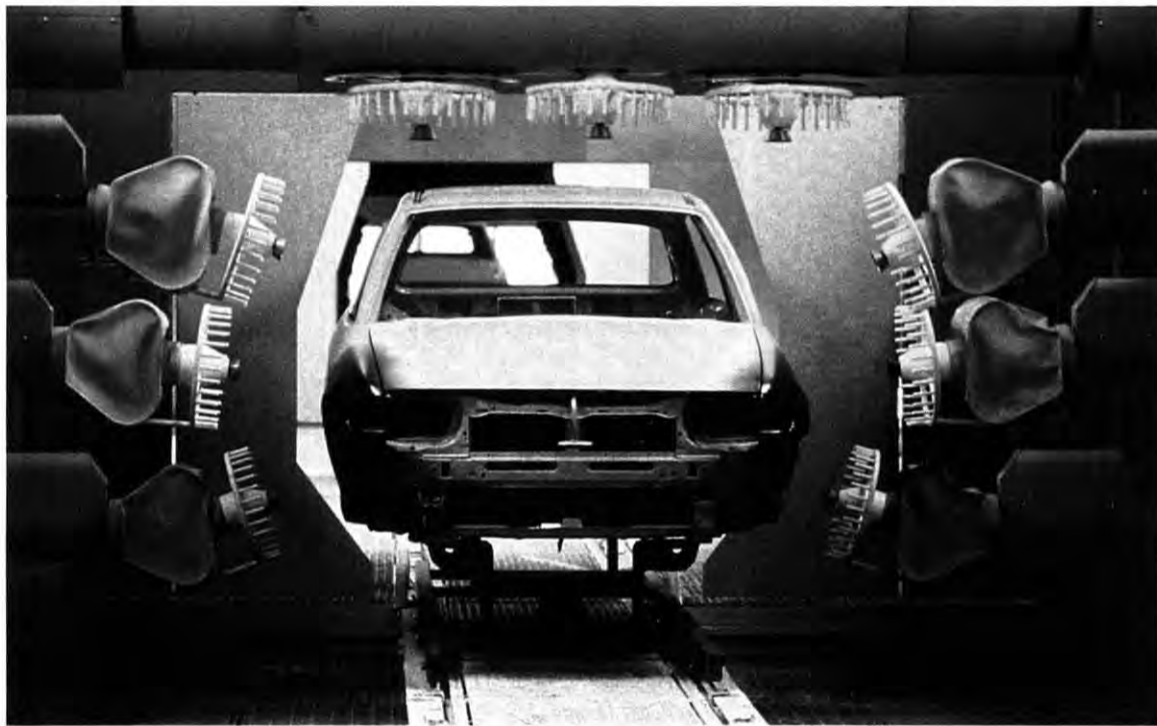
Sprüh-und-Spar: Durch die Verwendung von Rotationszerstäubern geht kaum Lack daneben
