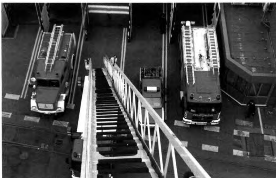
Luftbild: Bis auf 30 Meter fährt die Feuerwehrliefer aus
