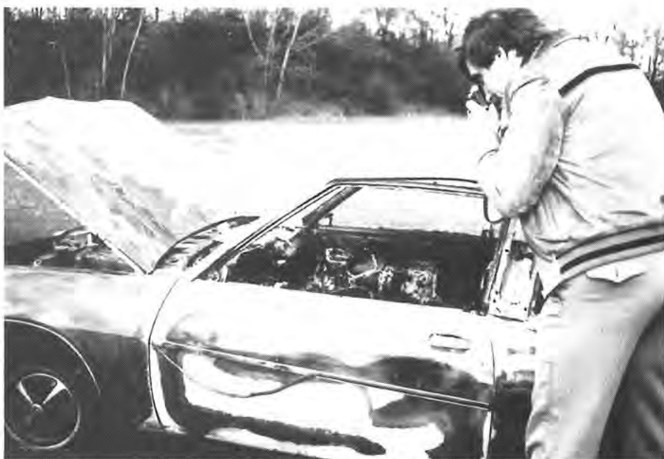
Der ausgebrannte Manta. H.-D. Zentgraf dokumentiert gerade die Brandschäden. Das Feuer wurde durch Entzünden von 5 Liter Benzin, im Kofferraum verschüttet, vorsätzlich gelegt und später von der Feuerwehr gelöscht.
