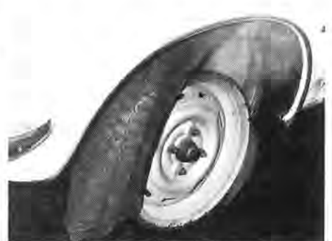
Typische Merkmale nach Fahren mit zu niedrigem Luftdruck: Das Profil ist noch erhalten, die Reifenseitenwand zerstört.
