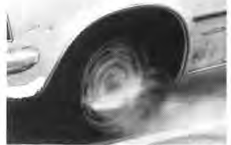
Nach wenigen Kilometern erwärmt sich der Reifen bereits so stark, daß er zu qualmen beginnt.
