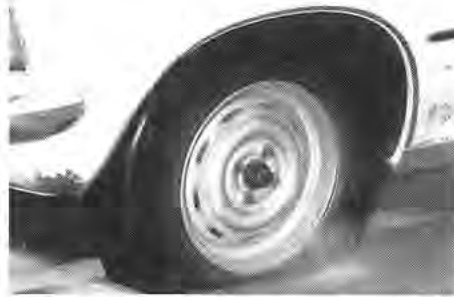
Der linke Vorderreifen wurde absichtlich auf einen Luftdruck von 0,3 bar abgesenkt.
