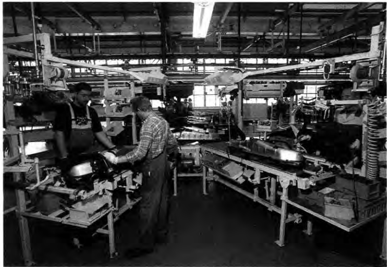
Vorarbeiter: Peter Kowert und Eduard Wolter bei der Tankvormontage (v. l.)
