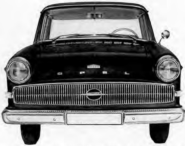
DAS GESICHT des Opel Kapitän „L“. Der tiefliegende, über die ganze Wagenbreite gezogene Kühlluftinlet und der glatte, gerade Stoßfänger lassen den Kapitän besonders breit und niedrig erscheinen. Die Scheinwerferlinge sind, als Blendschutz, schräg nach vorne gerichtet. Die Vollsicht-Panorama-Windschutzscheibe wurde 20 mm ins Dach hinaingezogen und damit der Sichtwinkel nach oben vergrößert (wichtig vor Verkehrsampeln)
