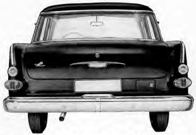
DAS HECK des Kapitän „L“. Das flache, schwach gewölbte Dach läuft über der vergrößerten Rückwand-Panoramasscheibe aus. Der großvolumige Kofferraum ist unter dem flachen, fast bis zur Wagenseitenlinie reichenden Deckel leicht und bequem „beschickbar“. Die ovale, waagrecht angeordnete Brems-Schluß-Blinkleuchten-Kombination, deren rechteckiges Mittelstück von einem Rückstrahler gebildet wird, wurde weit nach unten und außen gesetzt
