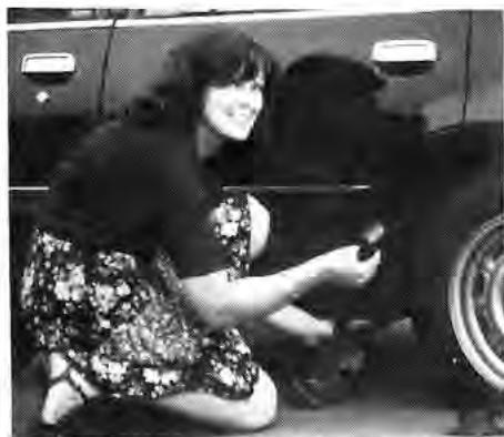
Abbildung 4: Den Dorn des Wagenhebbers in die Aufnahmevorrichtung am Fahrzeugboden schieben. (Genaue Beschreibung der einzelnen Arbeitsgänge im Textteil.)
