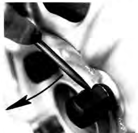
Abbildungen 1 und 2: Gezieltes Abheben von (je nach Modell) Radkappen oder Plastikdeckeln mit dem Schraubenzieher.
