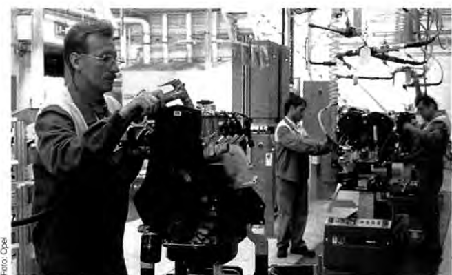
Bahnhof Opel, 1994: Auf zwei Montagelinien im 1928 erbauten, früheren Verladebahnhof – heute K 1 – bringen Opel-Mitarbeiter die in verschiedenen Baustufen angelieferten Aggregate auf einen einheitlichen Ausrüstungsstandard
