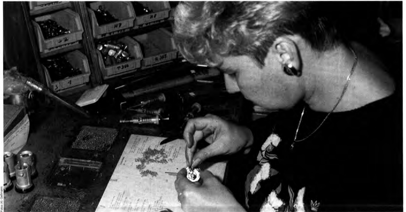
Geduldsspiel: Aus der Vielzahl möglicher Kodierungen setzt Karin Kessler das passende Lenkradschloß zusammen
