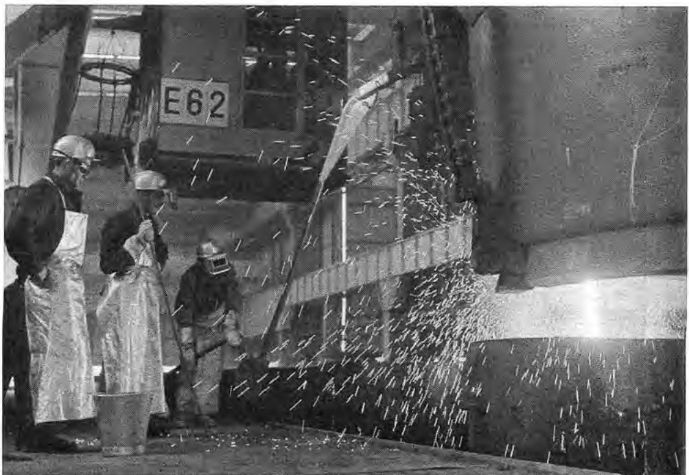
Abgießen von Rohstahl in Kokillen im Oxygen-Stahlwerk.
