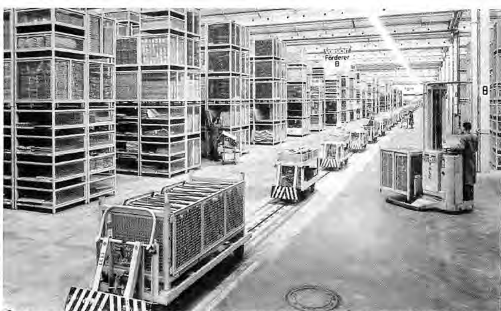
Der Unterflurförderer ist ein entscheidendes Bindeglied zwischen den einzelnen Abteilungsbereichen im Ersatzteillager. Wie von Geisterhänden geschoben, gelangen die Wagen selbständig an ihre Ziele. Deshalb auch der vom Betriebsmund geprägte Name „Geisterbahn“.
