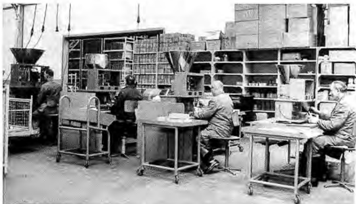
Zählwaagen und andere Präzisionsgeräte ermitteln schnell und zuverlässig die jeweils erwünschten Stückzahlen von Kleinstteilen für die Mengen-Verpackung.
