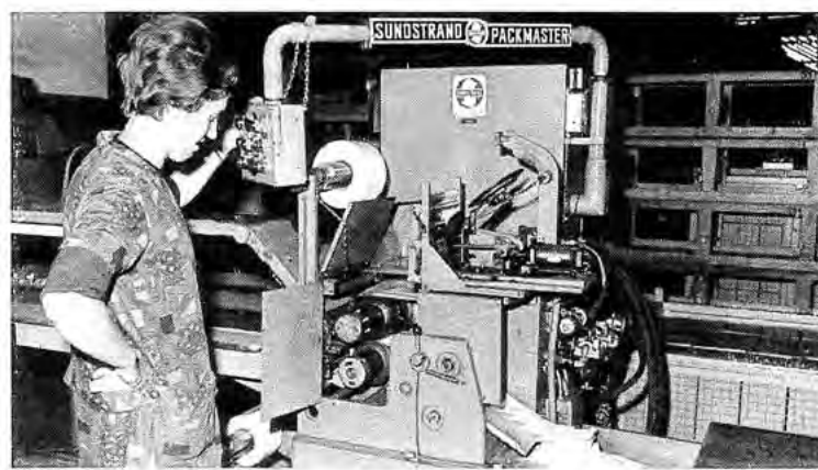
Ersatzteile und Zubehörartikel werden im „Packmeister“ in Kunststoffbeutel gefüllt, die gleichzeitig heißversiegelt werden.
