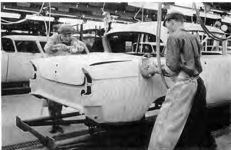
SCHLEIFEN des Grundlackes am Rekord. Nur dann kann eine einwandfreie Lackierung des Decklackes erreicht werden, wenn der Grund völlig glatt und sauber geschliffen ist. Für die letzten Feinheiten wird später noch mit der Hand nachgeschliffen. Auch ein Meilenstein auf unserem Wege zur Qualität
