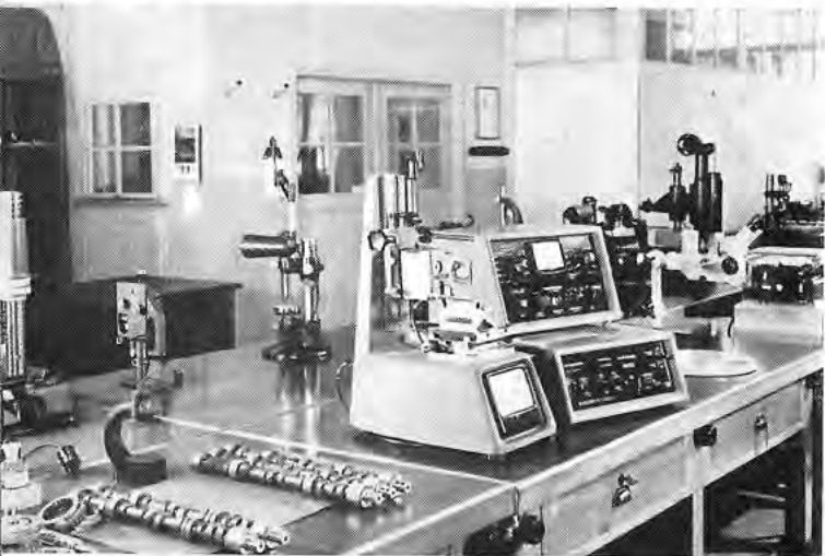
INSTRUMENT für die Messung von Oberflächen- güten; links ein Kleinlast- Härteprüfgerät
