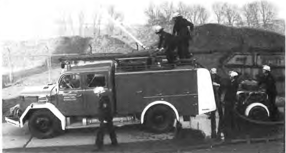
Einsatz eines Wasserwerfers (Monitor).
