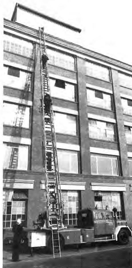
Die große Drehleiter DL 30 (30 m Steighöhe) im Einsatz.
