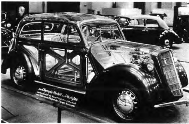
Tragende Rolle: Die erste selbsttragende Ganzstahlkarosserie
