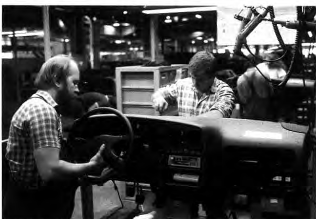
Modul-Konzept: Vormontage eines Omega-Cockpits ...
