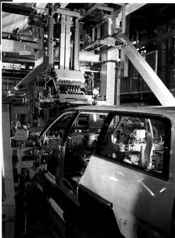
... und automatischer Einbau durch die Frontscheibe
