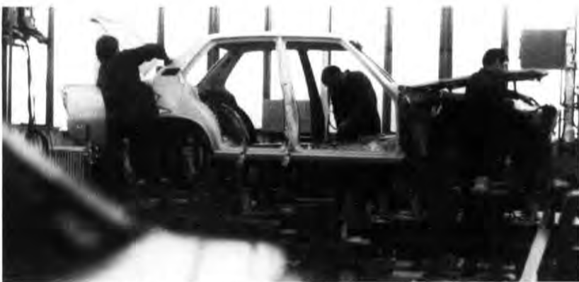
Versuchsbau: Jeder Testwagen wird von Hand gefertigt.
