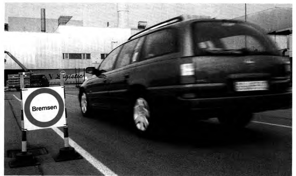
Rütteln und schütteln: Auf der Marterstrecke wird nach Geräuschen gefahndet und auch die Bremse kriegt eins aufs Pedal
