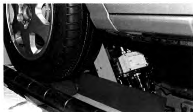
Angepackt: Statt wie früher in mühsamer und manueller Überkopparbeit wird die Spur an Astra und Zafira jetzt automatisch eingestellt
