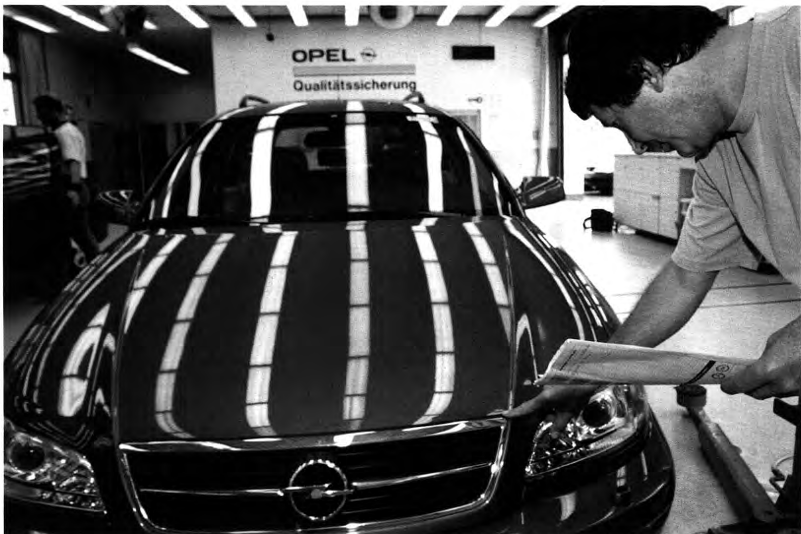
Geschulter Blick: Mit einer ausführlichen Sicht- und Funktionsprüfung beginnt das „Global Customer Audit“, dem sich 1,5 Prozent aller gefertigten Fahrzeuge, mindestens jedoch 15 Autos täglich, stellen müssen – europaweit in allen Opel-Werken
