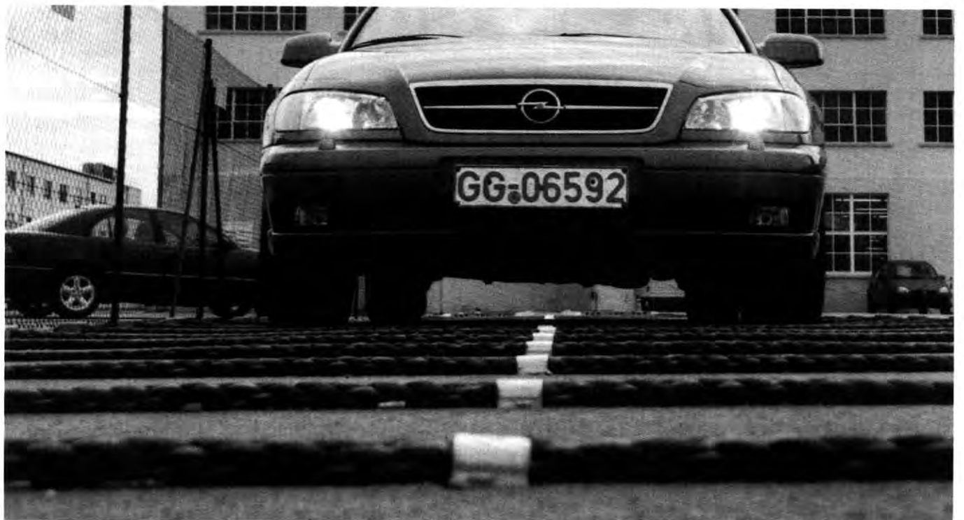
Rütteln und schütteln: Auf der Marterstrecke wird nach Geräuschen gefahndet und auch die Bremse kriegt eins aufs Pedal
