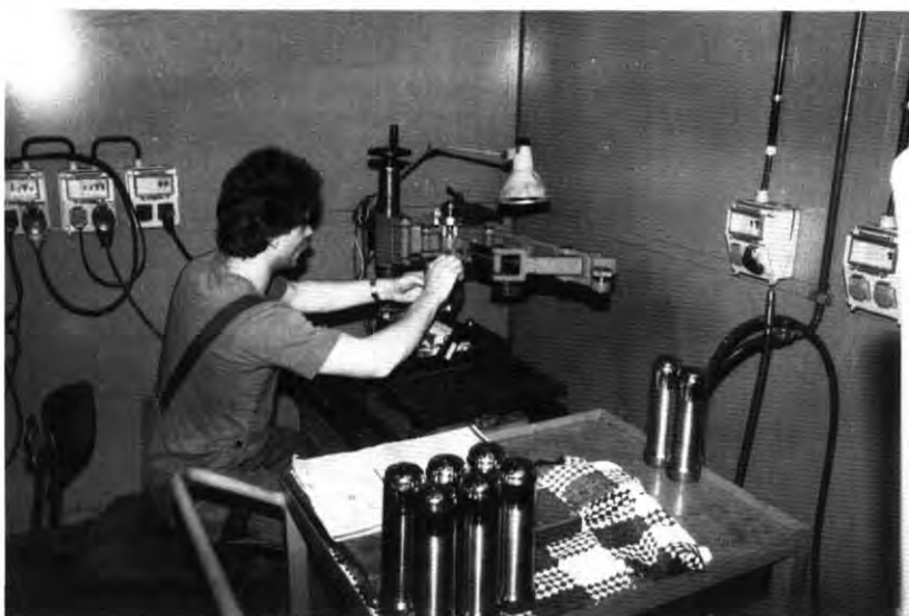
Die Mitarbeiter E. Schirra, H. Korn, H. Gensinger, V. Himmerlich, K. Appel und K. Kedzierski aus dem Bereich Hydraulik/Pneumatik- und Spindelreparatur. Im Hintergrund ein 1969 gebauter Hydraulik-Prüfstand. Hier werden alle im Werk zur Reparatur kommenden Hydraulik-Komponenten wie Steuerschieber, Druckeinstellventile, Mengenregler, Proportionalventile, Pumpen usw. geprüft.
