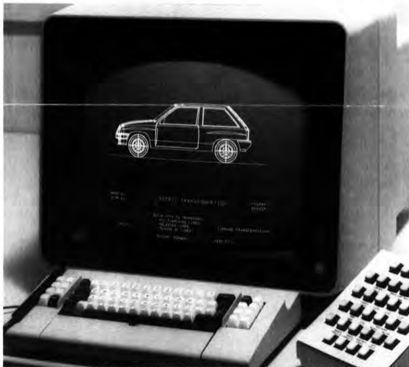
„Dialog“ mit dem Bildschirm für Autokonstruktoren: Computerunterstützte Konstruktionsmethoden (CAD = Computer Aided Design) ersetzen heute vielen Rüsselsheimer Ingenieuren das Reißbrett.
